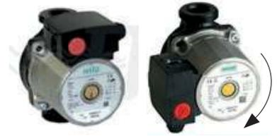
Moteur de rechange universel avec turbine et inverter à conversion de fréquence en classe énergétique «A» pour le remplacement sur les circulateurs domestiques "GRUNDFOS UPM et ALFA", modèles "ANTARES" et autres marques. Avec rotation à droite (CW). Avec prise de contrôle PWM et fonctions SELF ADAPT, PP, CP, CS. Autorégulant avec ou sans le branchement du câble au régulateur PWM.
